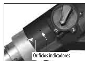
**ATENCIÓN: hay dos pequeños orificios en la parte superior de la cubierta de engranajes. Si alguno de esos orificios gotea indica que las juntas están desgastadas. Reemplácelas de forma inmediata.**
