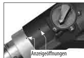
**ACHTUNG: Es befinden sich zwei kleine Öffnungen an der Oberseite des Getriebegehäuses. Wenn aus einer dieser Öffnungen Wasser austritt, bedeutet dies, dass die Wasserdichtungen verschlissen sind. Ersetzen Sie sie sofort.**
